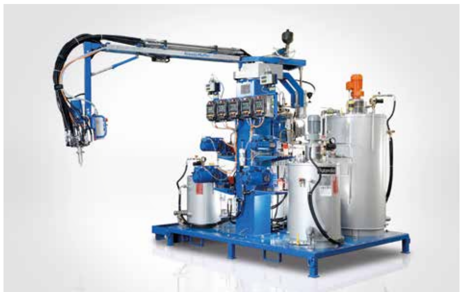
F系列用于低压反应铸造（较低输出率）
